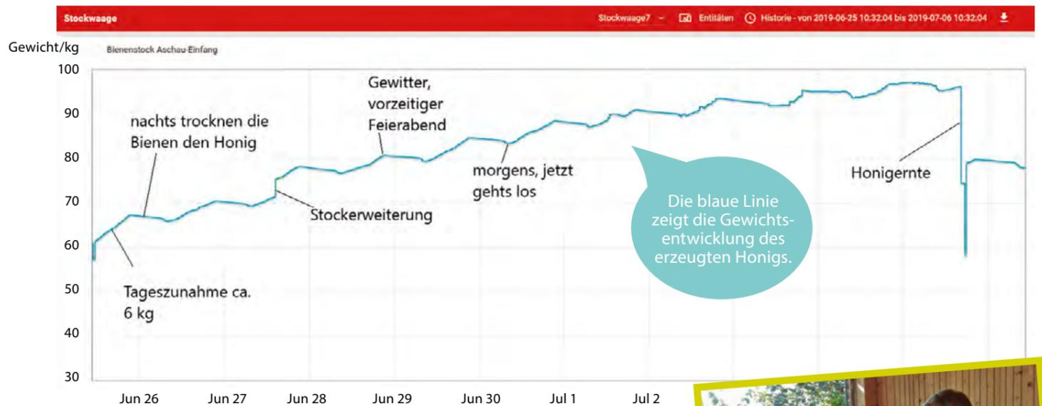
Inzwischen sind ca. 14 solcher Bienenstockwaagen im Landkreis Rosenheim bei diversen Imkern in Betrieb
